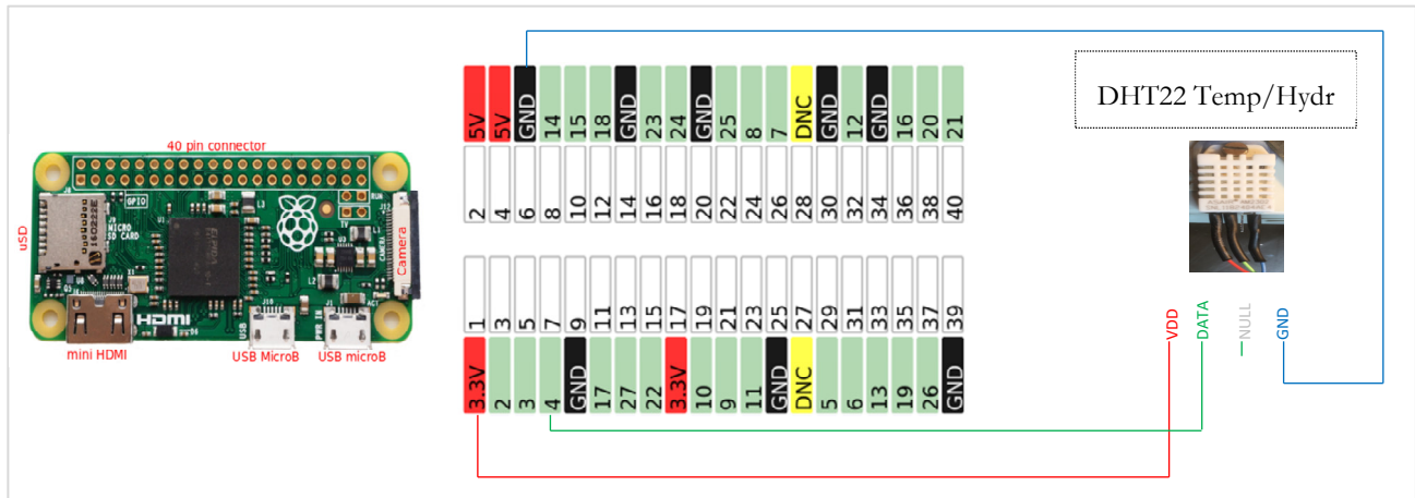
Abbildung 6: Verdrahtungsplan Sensor
