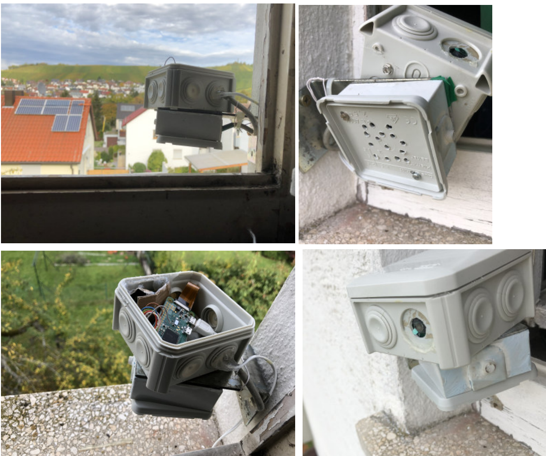
Abbildung 50: Entmontage der Wetterstation 9
